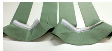
Stolien suojaksi laitettu kuitukangas ei ollut estänyt hikitahrojen synty-
